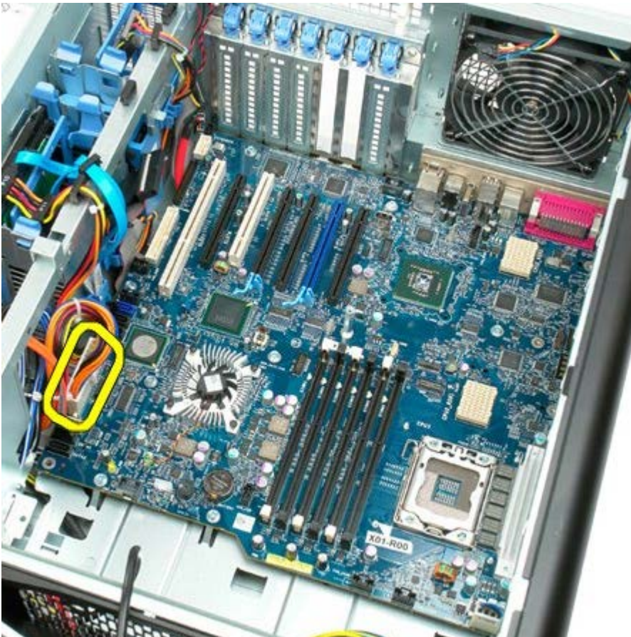
17. Koppla bort kabeln för den optiska enheten.
