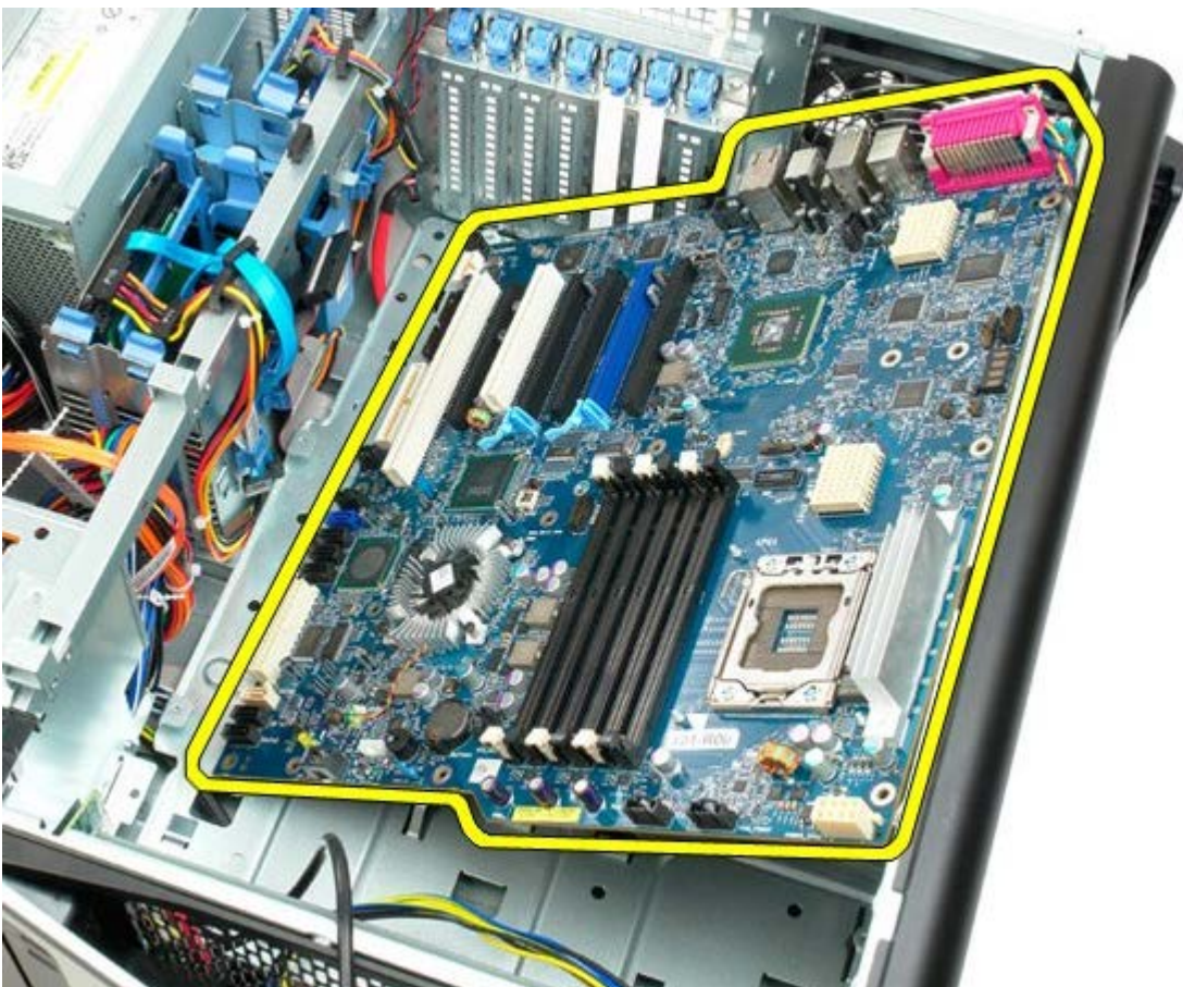
22. Ta bort moderkortet från datorns chassi.
