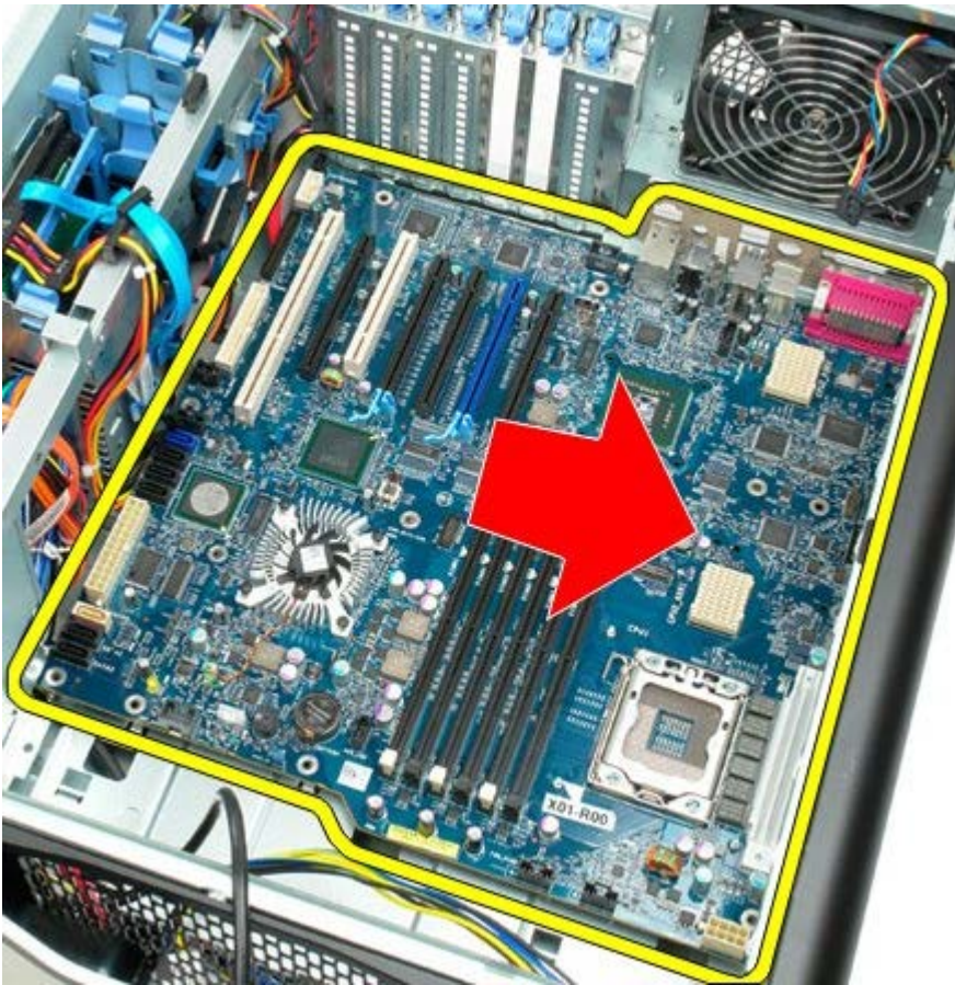
22. Ta bort moderkortet från datorns chassi.
