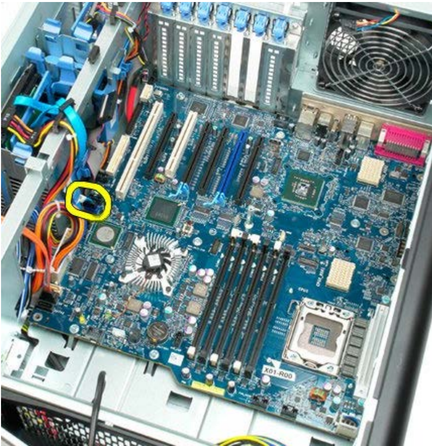
16. Koppla bort strömkabeln.
